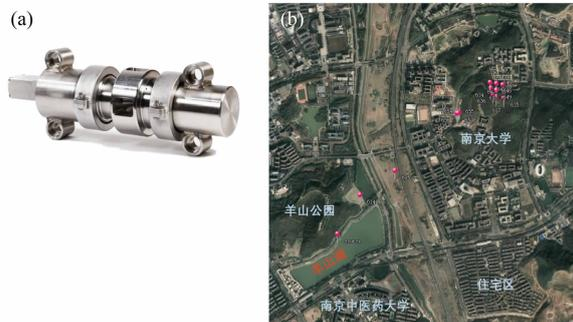
图 2 (a) Teledyne Bolt 1900LL 型气枪震源; (b) 试验区域卫星图(红色标记为台站位置)
